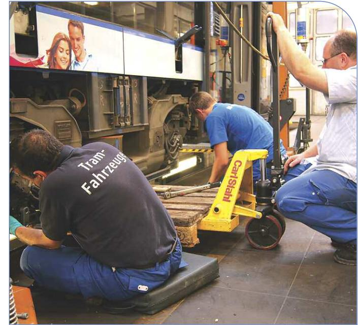
In der Werkstatthalle in der Einsteinstraße werden die Trambahnen auf Herz und Nieren geprüft. Eine Tram von oben: Die aufwendige Technik steckt bei niederflurigen Fahrzeugen im Dachgepäck. Werkstattmitarbeiter tauschen bei einer Tram die Schienenbremsen aus.
